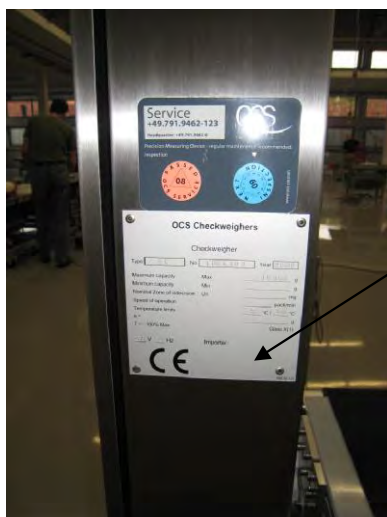
Рисунок 3 - Место нанесения знака поверки
